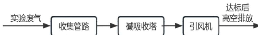
图 4-1 本项目实验废气处理工艺流程图
